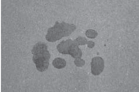
浸透性吸水軽減材塗布品：水染みあり
