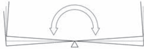
支点金物等を設置しセンターロッキング
