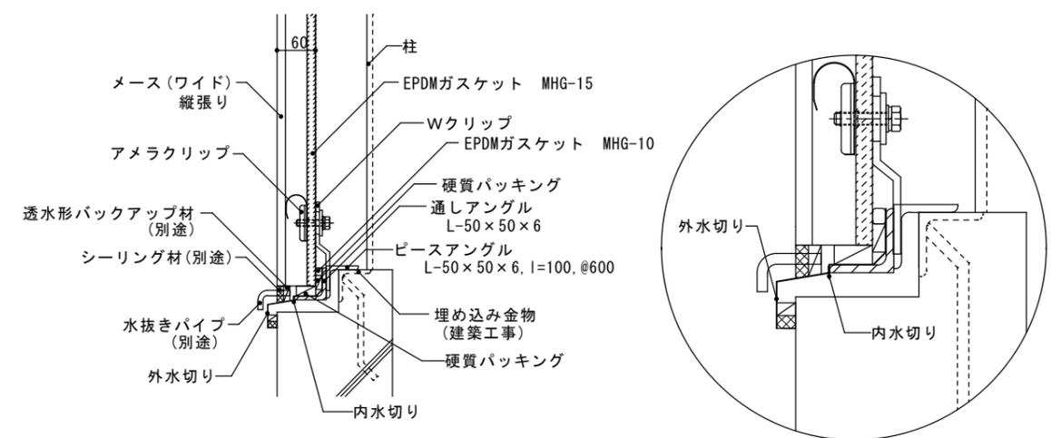
下部(組み合わせ水切)断面図
