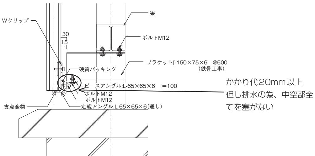
★：重量受け通しアングルがメースの中空部を全て塞ぐ場合は、排水の為支点金物を取り付けて下さい。
