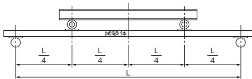
図5 曲げ強度試験
