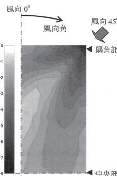
図7.2.27 屋根面の負のピーク外圧係数<sup>42)</sup>
