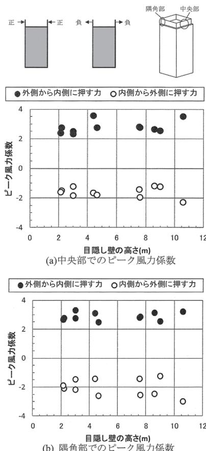
図7.2.28 高層建築物の目隠し壁のピーク風力係数<sup>44)</sup>
