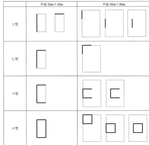
図より、端部および中央部における最大ピーク風力係数の大きさは、I型の場合に大きい。最小ピーク風力係数の大きさ(絶対値)については、端部では形状により差はあまりないが、角部、中央部では、L型の場合が他の形状に比べてやや大きい。また、口型は他の形状と同程度がやや小さめの値を示す。
